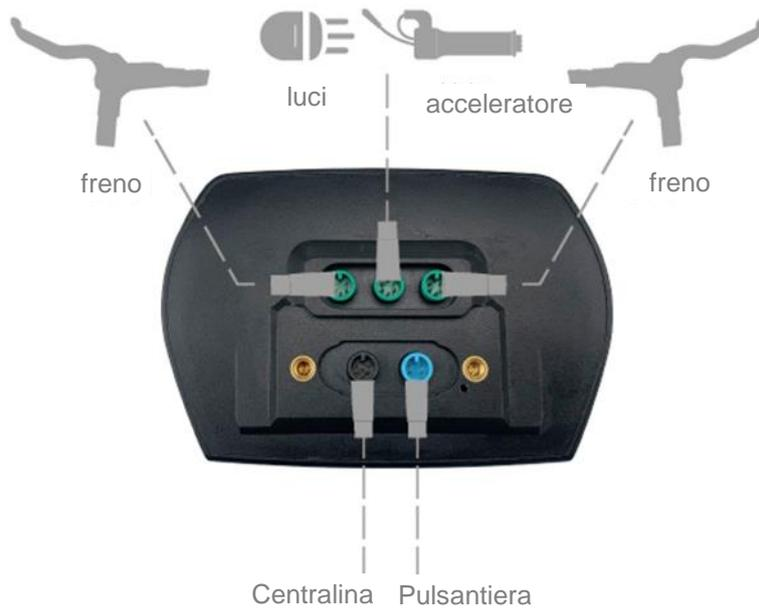
Figura8 - Connessioni diagramma B
