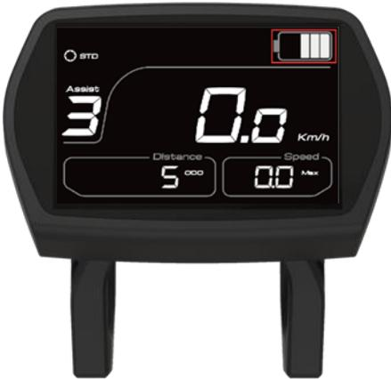
Figura11-9 stato di carica della batteria
